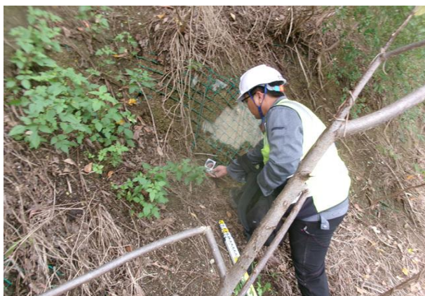
절리면 경사/경사방향 측정
